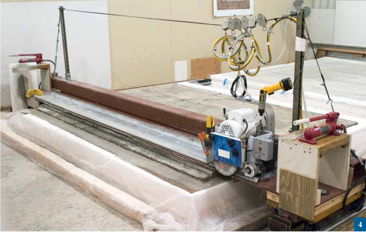
منظومة الجسر المصممة وفق الطلب التي أستخدمت لدعم المنشار الدوار ونظام التبريد في أثناء تقليل الخرسانة. تصوير: سارة ديشينس ©
