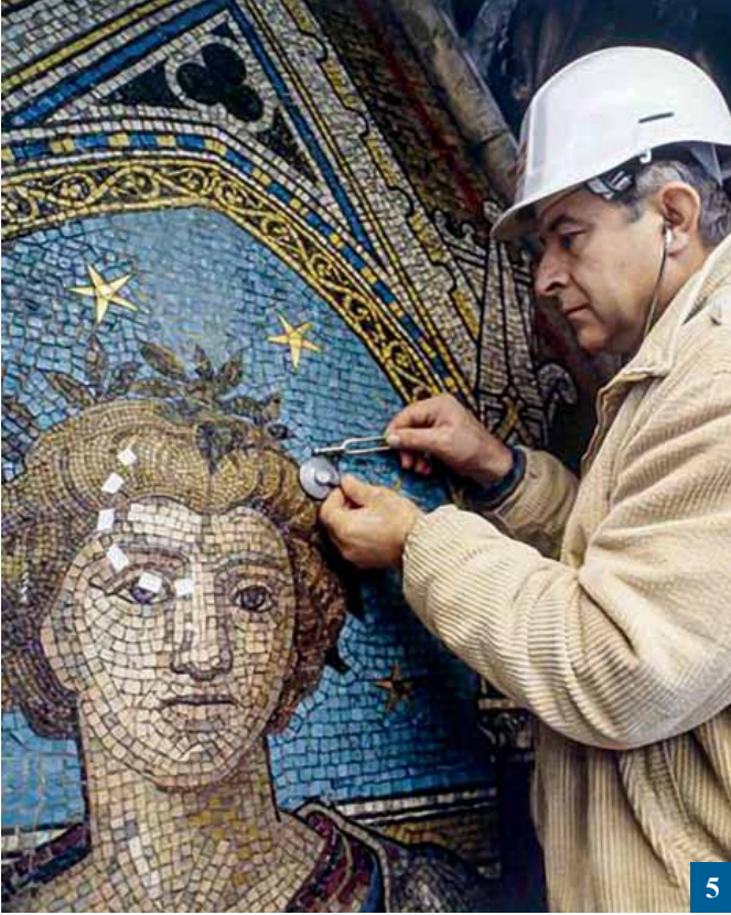
جيوفاني كوكو أثناء مسحه للفسيفساء التي على الجملون الشمالي. استخدمت شوكة رنانة وسماعة طبيب لتحديد مناطق الانفصال. تصوير: هيئة التراث الإنجليزي
