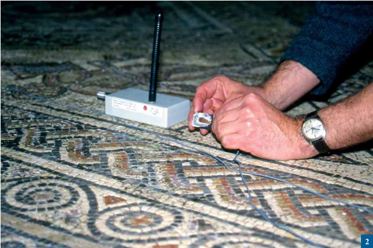
استخدام جهاز استشعار درجة حرارة السطح للفسيفساء، موصلاً بجهاز إرسال لاسلكي بكابل
