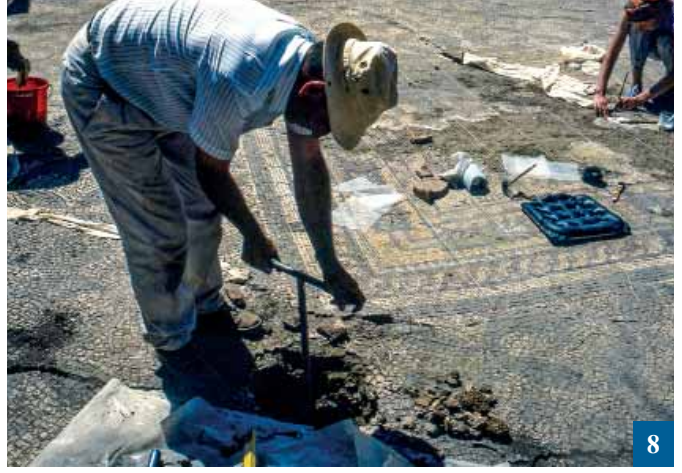
الحفر وإخراج عينة من جوف التربة من داخل فتحة في أرضية الفسيفساء لتحديد مدى استقرار الطبقة الجيولوجية التحتية. سغالاسوس، تركيا
