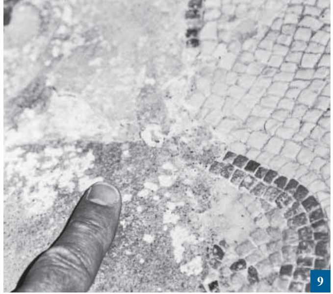
تراكم الأملاح القابلة للذوبان بفعل الخاصية الشعرية للأرض. فسيفساء محمية بسقيفة في (بافوس) بقبرص. تصوير: ن. أغنيو. الحقوق محفوظة لمؤسسة بول غيتي ©
