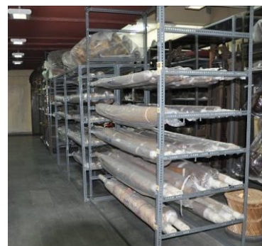
Étagères modifiées , dotées de barres horizontales pour soutenir des tubes © ICCROM
