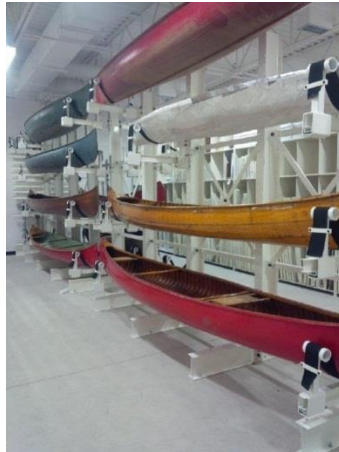
Rayonnages en porte-à-faux
