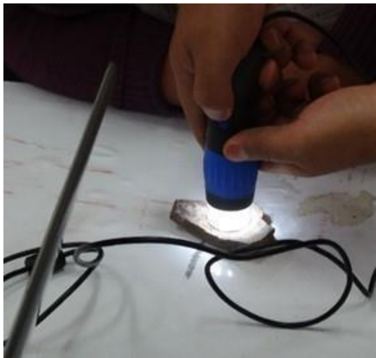
Imagen 15: Practicas de laboratorio con utilización de microscopio USB para la caracterización óptica de muestras.
