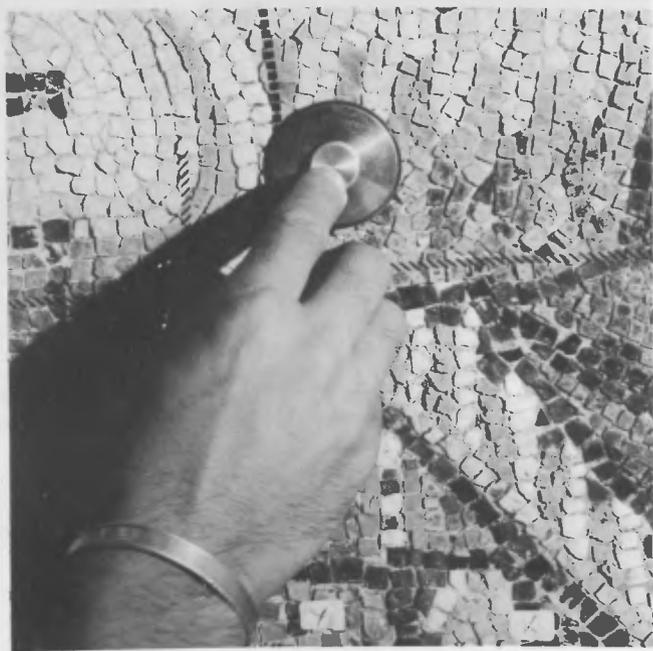
Foto N°4: Particolare del rilevamento del suono trasmesso attraverso uno stetoscopio.
