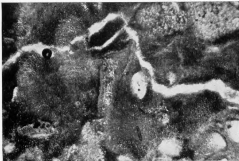
FIG. 23.— Seminario de Baeza. Grietas paralelas a la superficie. Nicoles paralelos, X 35
