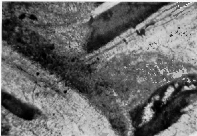
FIG. 12 (p. 67) — Cathédrale de Tarragone. Accumulation d'oxyde de fer en des points précis. Nicols parallèles, \times 35 .
