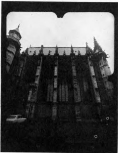
Fig. 6 - Redressement d'une photographie prise avec une inclinaison systématique de 30 grades, l'axe de la chambre étant placé dans un plan perpendiculaire au sujet - a) Photographie originale - b) Photographie redressée. (Sainte-Chapelle du Château de Vincennes, près de Paris)
