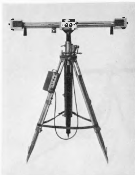
Fig. 3 - Deux chambres stéréométriques . - a) Chambre Wild C. 120, vue de dos (format 6,5×9 cm.; focale 65 mm.) - b) Chambre Zeiss Jena SMK 5,5/0808/120, vue de face (format 8×8 cm.; focale 55 mm.). Pour la chambre Carl Zeiss SMK-120, voir la publication de H. Foramitti: « La photogrammétrie au service des conservateurs »
