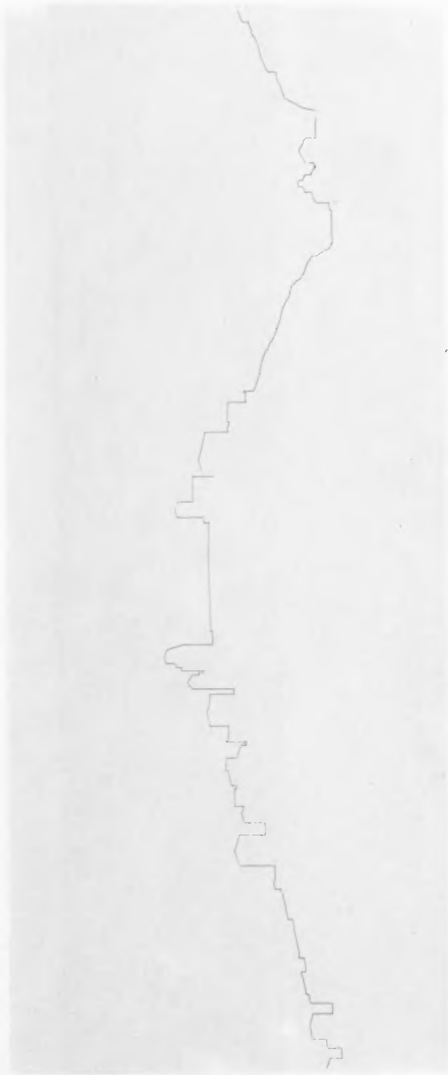
Fig. 6 - Coupe Ouest-Est du quartier Sud de la ville de Thiers, établie par restitution stéréophotogrammétrique. La trace de cette coupe est indiquée sur le plan de la figure 4 b. (Document IGN-France)
