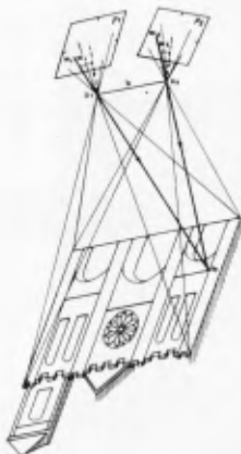
③ Orientation relative des faisceaux perspectifs. Formation du modèle à l'échelle \frac{b}{B}
