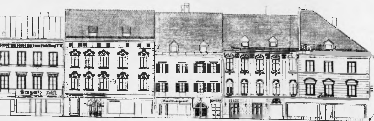
Fig. 13 - Développements de façades relevés par restitution stéréophotogrammétrique. En haut, Obernberg am Inn, Marktplatz. En bas, Klagenfurt, Alter Platz. (Relevés du Bundesdenkmalamt, Vienne, Autriche)
