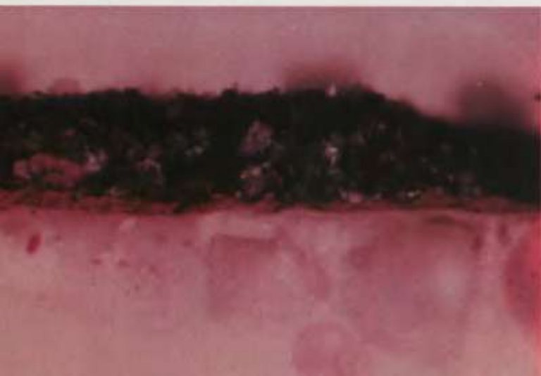
Pl. V - Pietro Lorenzetti, Déposition , Assise, Basilique Inférieure. Coupe dans le ciel, montrant, de bas en haut, l'enduit, une couche de terre rouge appliquée à fresque comme ton de base, et la couche bleue d'azurite exécutée à sec sur la couche de base.
