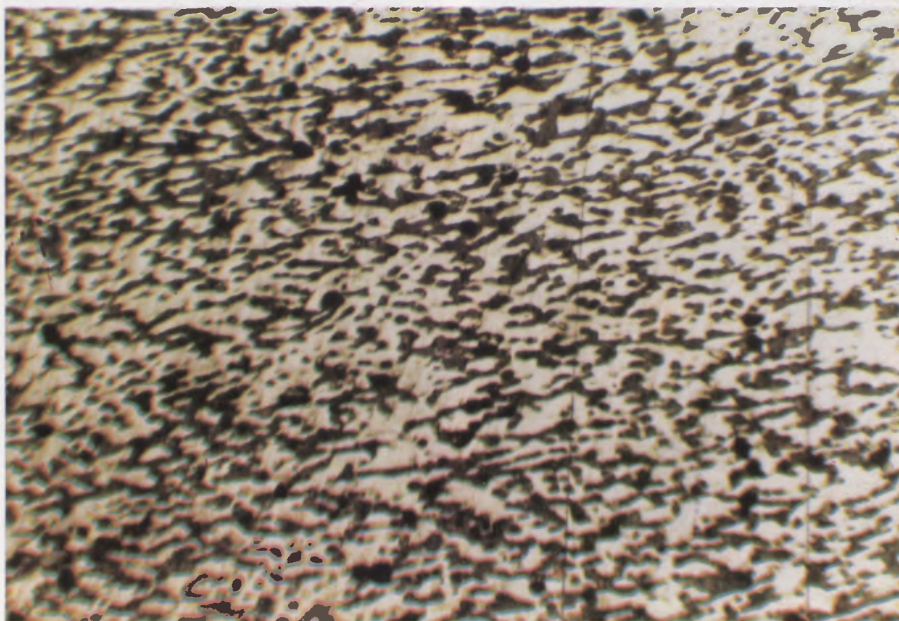
Fig. 35: Monnaie d'argent moderne, faux d'Agrigente. Les grains sont allongés, le métal est écrasé et non frappé après recuit. \times 100 .
