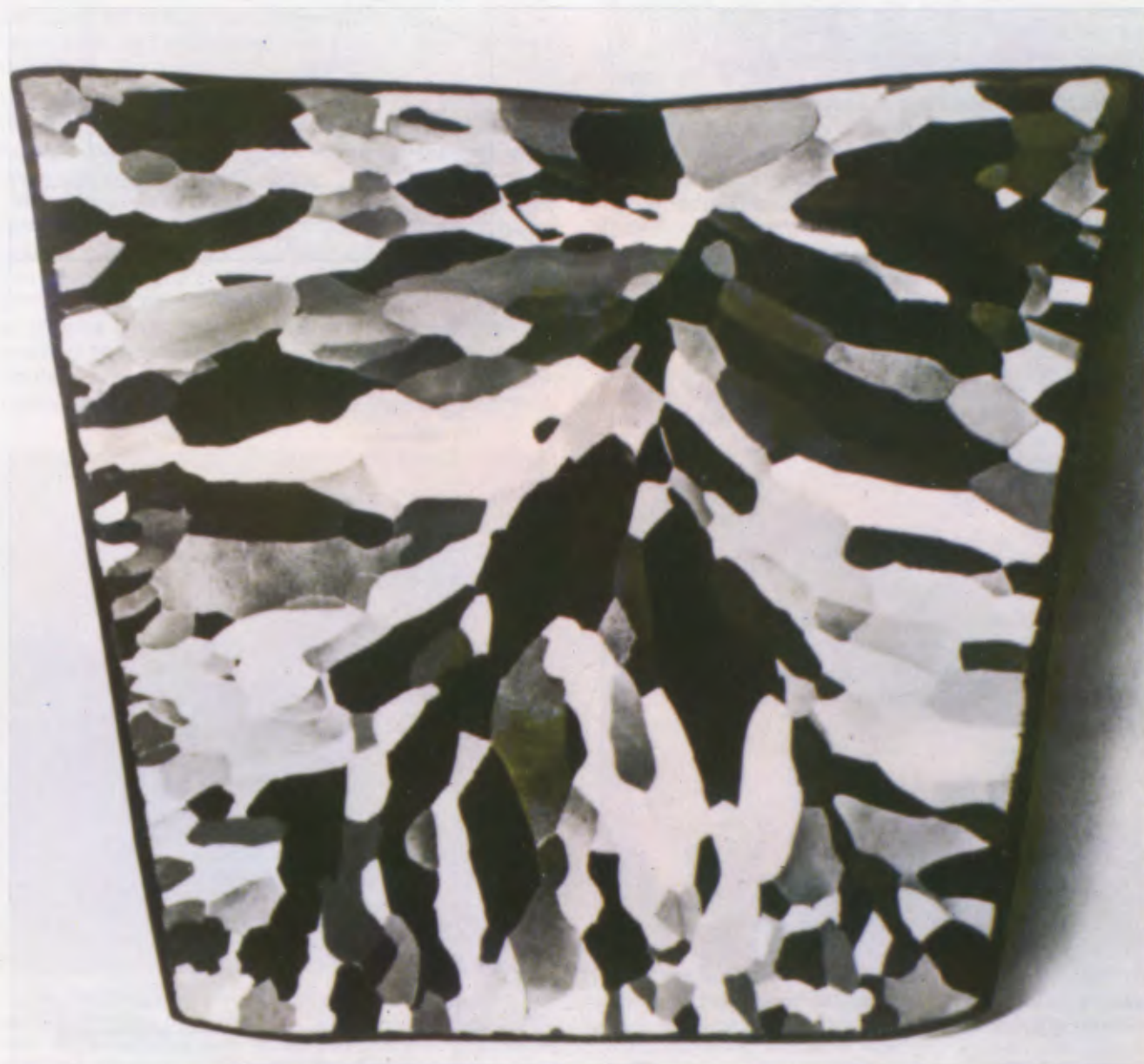
Fig. 42: Section d'un petit lingot de plomb très pur (99,99%). Gros grains equiaxiaux, leur grande taille est due à l'absence d'impuretés qui constituent des germes de grains. Photo American Society for Metals. x 6.
