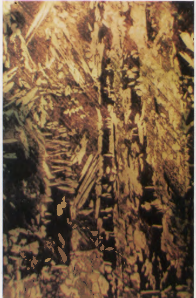
Fig. 13: Laiton au nickel, filé puis étiré à froid. Structure fibreuse. \times 200 .
