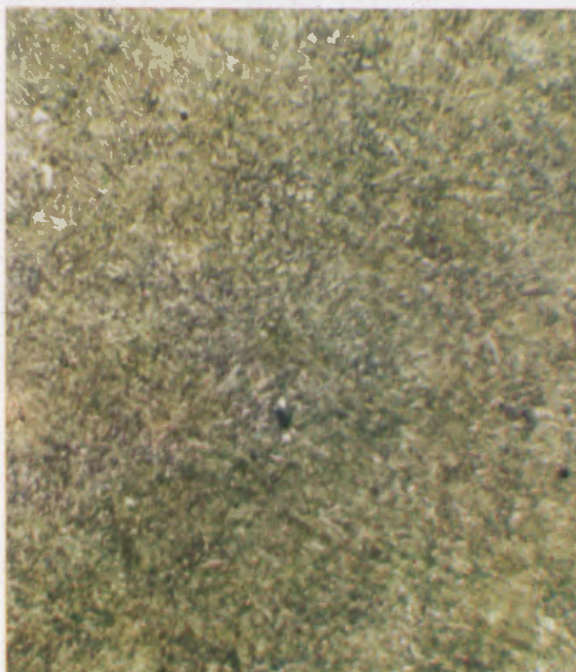
Fig. 64: Même acier que le précédent, mais revenu 2 heures à 600°. Petites particules de carbure de fer dans une masse de ferrite aciculaire. \times 200 .
