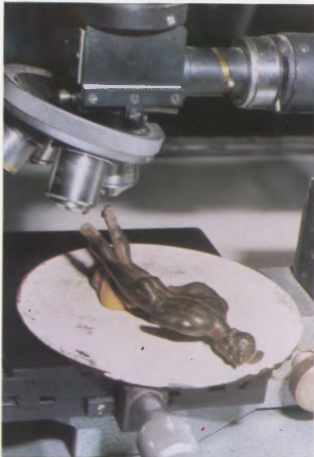
Fig. 76: Les dimensions réduites de l'objet permettent de le placer sur la platine du microscope métallographique.
