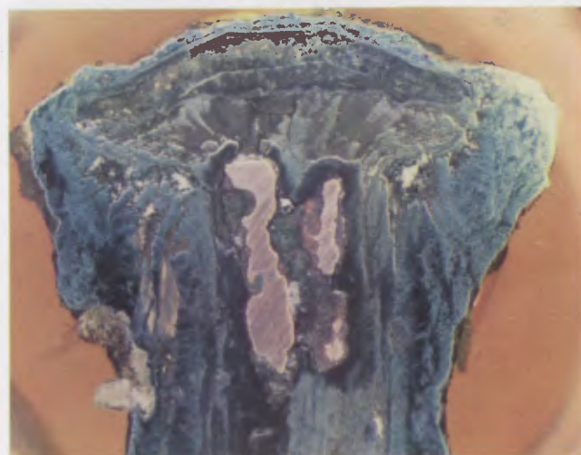
Fig. 51: Bracelet protohistorique, bronze final. Métal coulé, non recuit. Gros globules de plomb, phase corrodée. Analyse: Cu 77,5 %; Sn 13 %; Pb 6,6 %; Fe 0,6 %; Zn 0,8 %. × 100.
