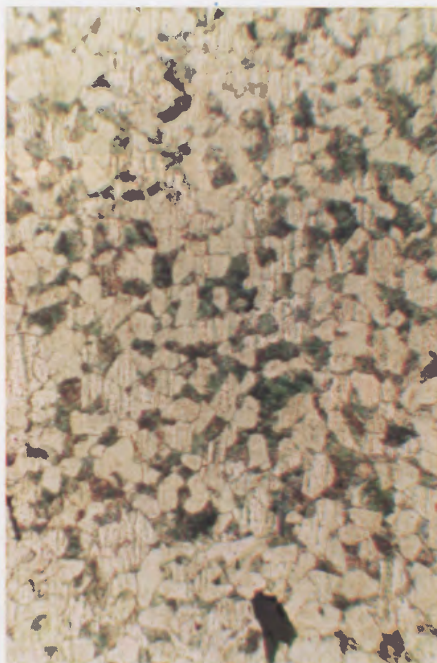
Fig. 59: Fer ancien (Luristan). Fer légèrement carburé. Les grains foncés sont constitués de perlite qui contient 0,88 % de carbone. Les grains clairs sont de la ferrite. La proportion des deux constituants permet de déterminer la teneur en carbone, ici 0,2 %. \times 100 .
