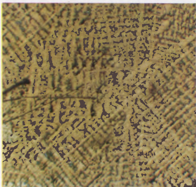
Fig. 45: Fragment de torque, Hallstatt final. Structure de coulée, dendrites non déformées. L'objet n'a pas été coulé dans sa forme définitive. Teneur en étain de l'ordre de 10 %. \times 100 .
