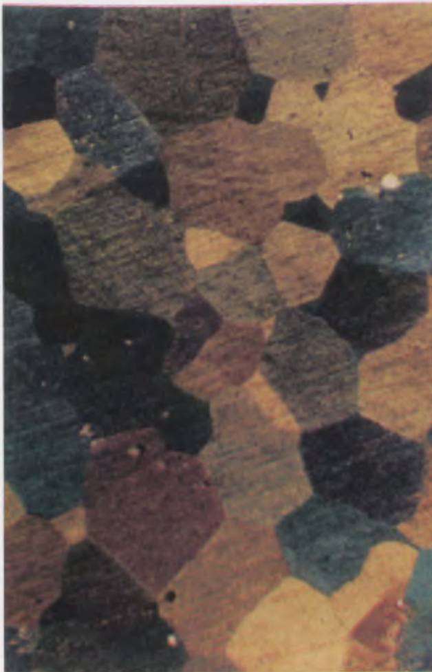
Fig. 12: Laiton à haute résistance, filé. Grains réguliers. \times 100 .
