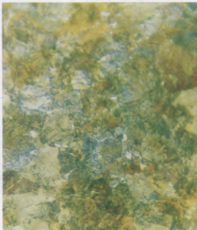
Fig. 65: Acier avec 0,80 % de carbone. Essentiellement perlite avec 5 % de ferrite en petites plages. \times 400 .
