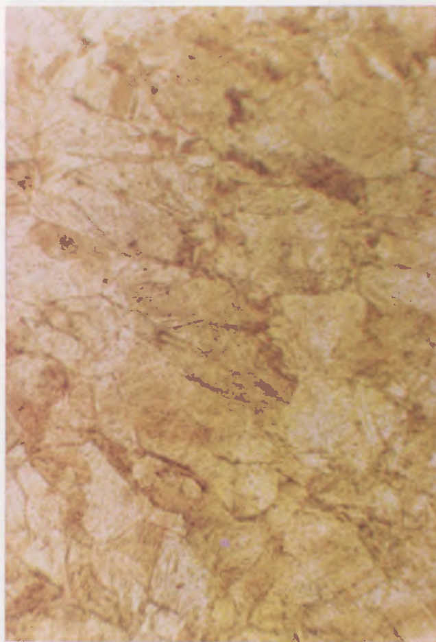
Fig. 32: Or fin recuit puis martelé à froid. On constate la déformation des grains due à l'écrasement et des fissures dans les grains. \times 100 .
