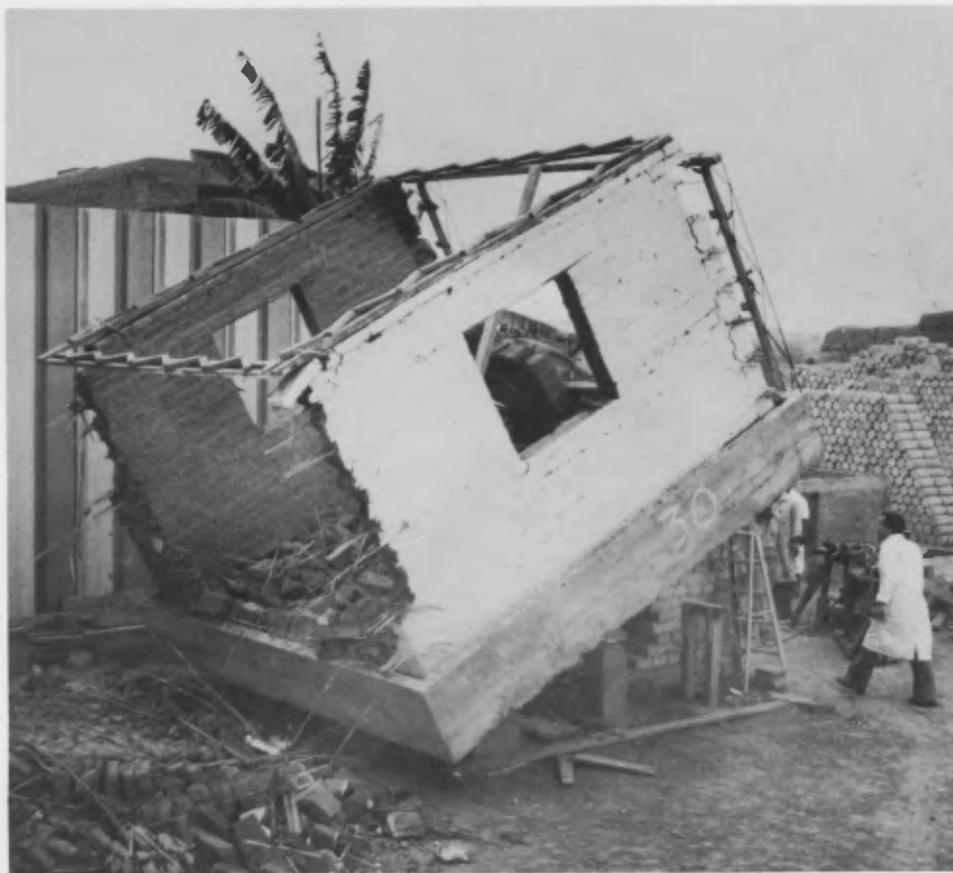
Experimentos realizados en la Universidad Católica del Perú para lograr construcciones sismorresistentes en adobe.
