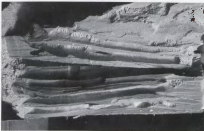
Fig. 36 - Gallerie scavate da cerambicidi; sulle loro pareti sono evidenti le caratteristiche striature che somigliano a quelle lasciate sulla sabbia dalle maree.
