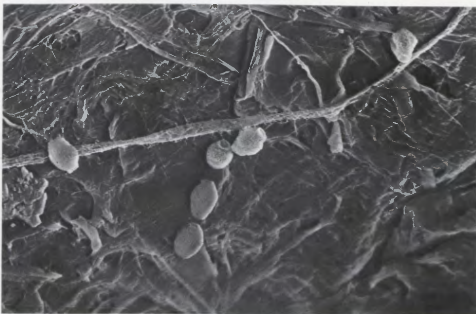
Fig. 55 - Carta con macchie di foxing esaminata al microscopio elettronico a scansione: spore e ife in corrispondenza delle alterazioni cromatiche.
