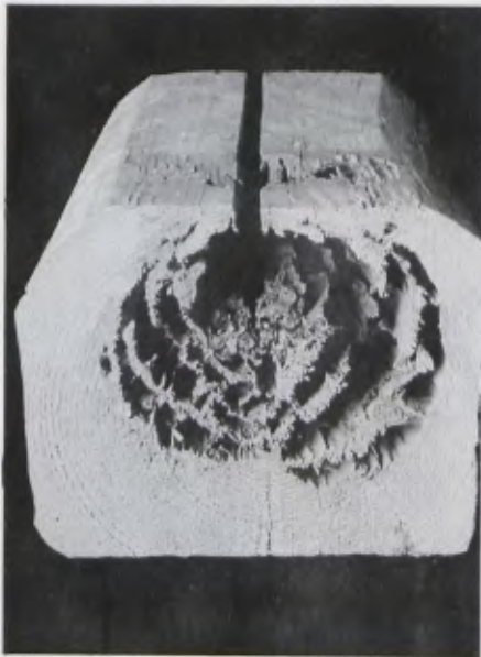
Fig. 17 - Legno che, a causa di un attacco termitico, ha assunto un aspetto lamellare. Gli insetti hanno distrutto gli strati primaverili ed hanno lasciato intatti quelli autunnali.
