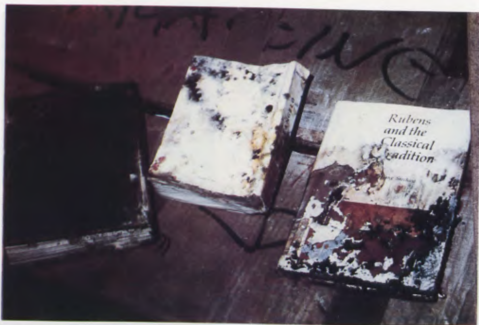
Fig. 50 - Agglomerati di ife e spore fungine su volumi conservati in ambienti umidi.
