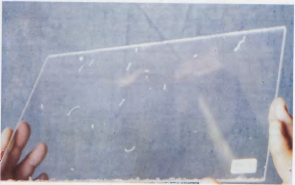
Fig. 24 - Lastra di plexiglass perforata da anobidi.
