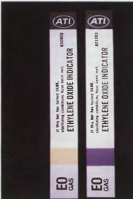
Fig. 60 - Indicatori chimici. La banda colorata gialla vira nel campo dell'azzurro quando viene a contatto con l'ossido di etilene.
