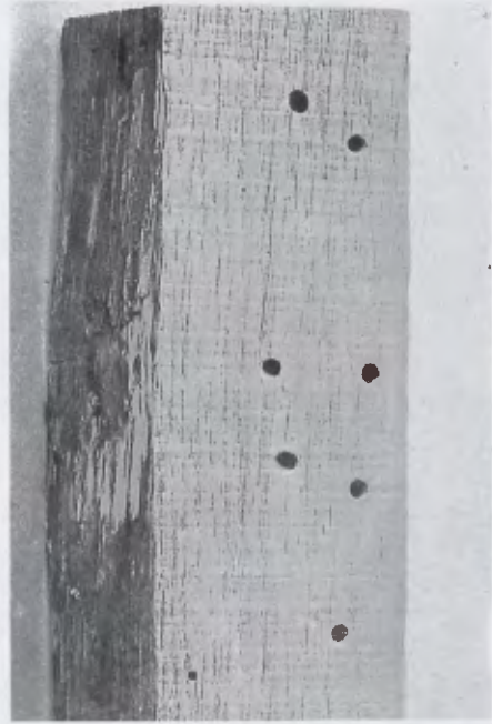
Fig. 25 - Fori di sfarfallamento di anobidi su legno.
