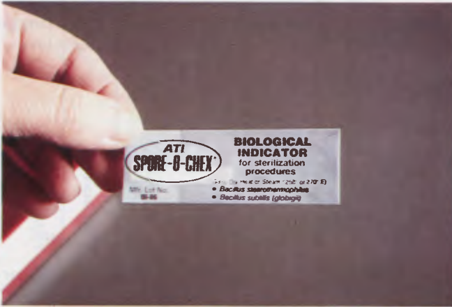
Fig. 61 - Indicatore biologico. Strisciolina di carta, inocolata con spore contate di Bacillus subtilis (niger), racchiusa in un involucro di carta che la protegge dall'inquinamento atmosferico.
