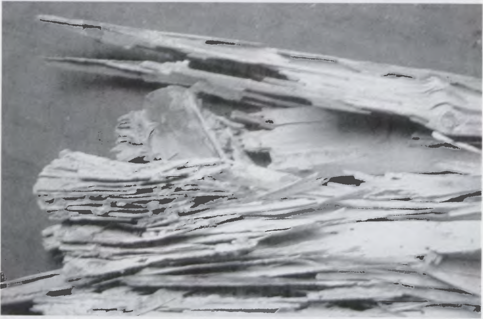
Fig. 17 - Legno che, a causa di un attacco termitico, ha assunto un aspetto lamellare. Gli insetti hanno distrutto gli strati primaverili ed hanno lasciato intatti quelli autunnali.
