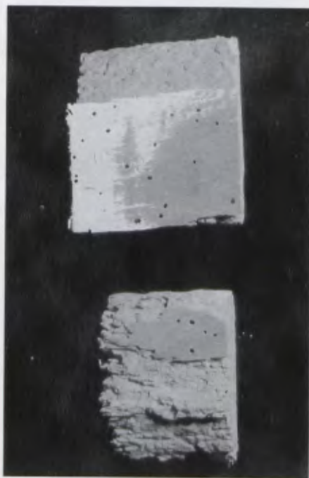
Fig. 35 - Legno danneggiato da lictidi.
