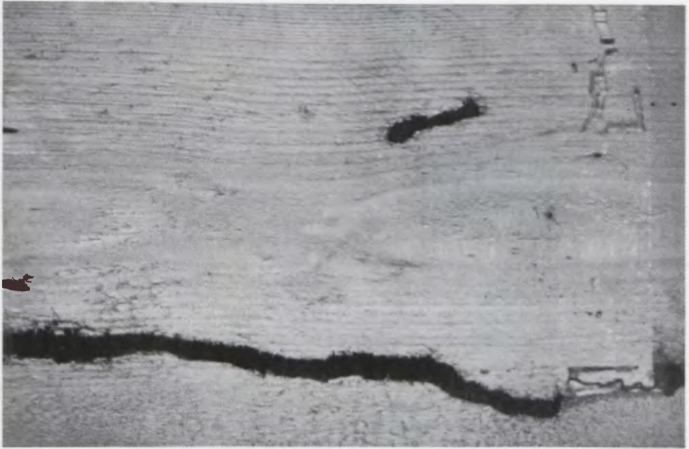
Fig. 12 - Camminamento costruito da Reticulitermes lucifugus su una tavola lignea.
