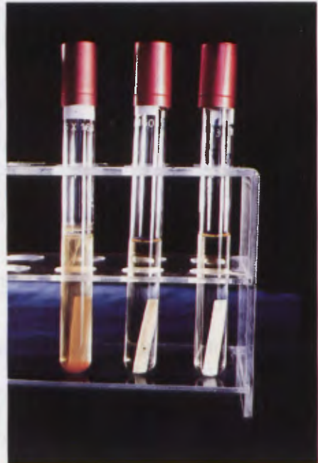
Fig. 60 - Indicatori chimici. La banda colorata gialla vira nel campo dell'azzurro quando viene a contatto con l'ossido di etilene.
