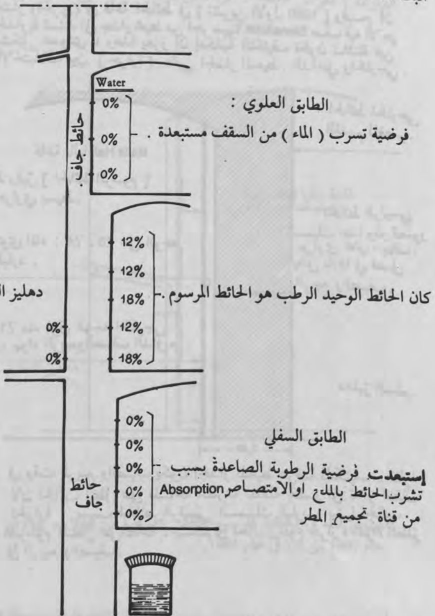
شكل - 9 - قياسات محتوى الماء في الحائط المرسوم (عليه) . ٤٧
