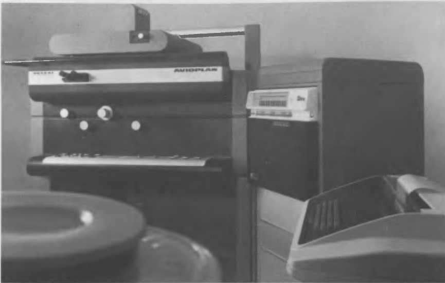
Figure 52 Un orthoprojecteur à commande numérique. Avioplan OR.1 Wild-Heerbrugg. A numerically-controlled orthoprojector. Avioplan OR.1 from Wild Heerbrugg, Switzerland.
