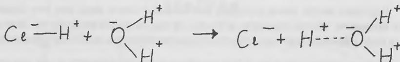
La reazione di ionizzazione si svolge in un solo verso e produce uno ione idrogeno per ogni molecola di acido cloridrico o nitrico (l'acido solforico libera 2 ioni idrogeno per ogni molecola).
