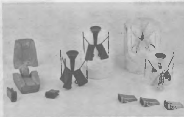
Modèles démontrant le processus de la fonte à la cire perdue. A partir de la gauche: modèle en bois, moule en argile pour faire des modèles en cire, un modèle en cire, section à travers les cires pour leur moulage, section après la fonte de la cire, objet fondu tel qu'il sort du moulage, étapes de finition. Photo de B. Malter.
