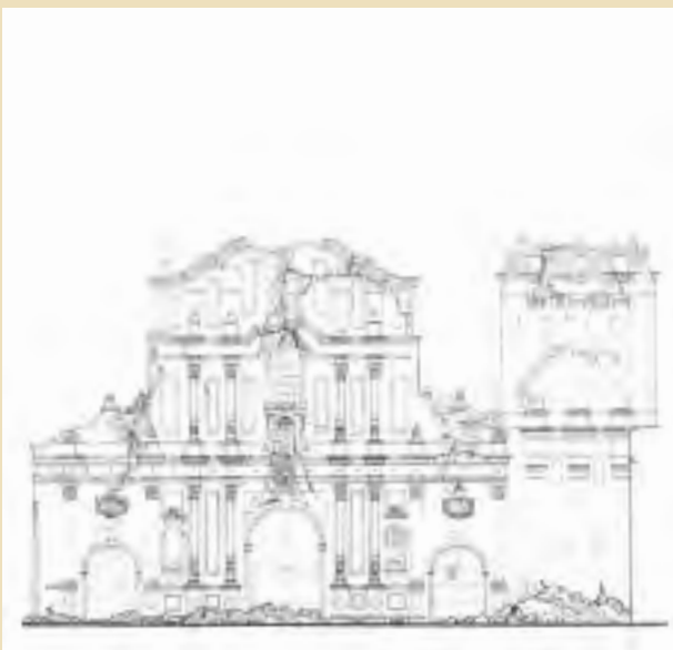
Etat de conservation de la façade de l'église San Francisco le 5 avril 1983, après le tremblement de terre. Les croquis sont de Jaime Moncada Calixto, de l'Instituto Colombiano de Cultura (Colombie).
