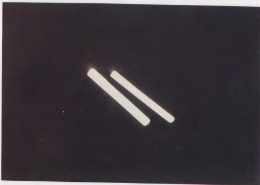
Foto 2.— Perni ceramici di allumina, filettati, di due diametri diversi.
