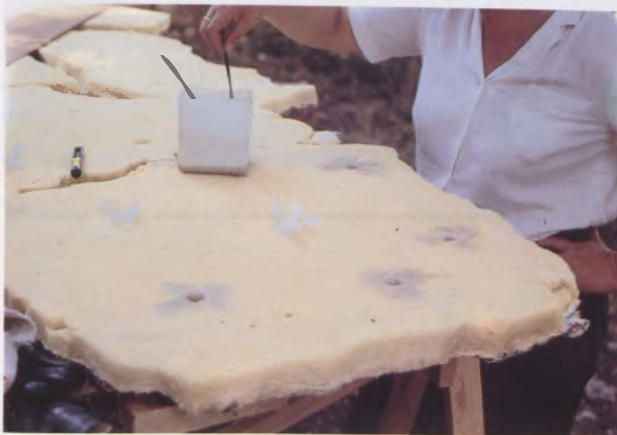
Fig. 6.— Strato di poliuretano per la nuova posa dei frammenti in signino, con fori per l'armatura in vetroresina.
