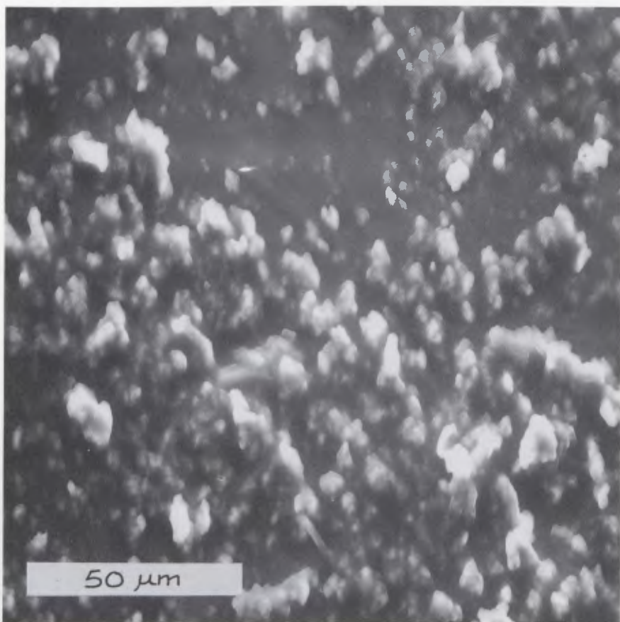
Figure 5: Microfoto SEM di una superficie di Tessera vetrosa con patina salina.
