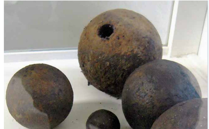
كرات مدفعية تعاني من الصدأ والتآكل بسبب الرطوبة النسبية العالية (نشرت الصورة بإذن من السيد خوسيه بيدرسولي جونيور).
