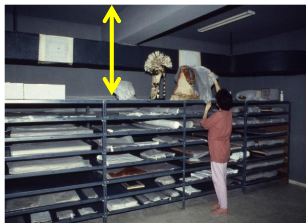
Lo spazio verticale utilizzabile non è lo stesso in ogni stanza, in quanto c'è la possibilità che siano presenti impianti o altri ostacoli (in questo caso, impianto di ventilazione) © ICCROM
