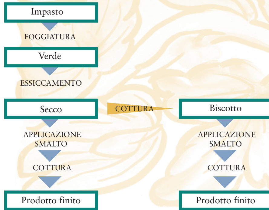
FIGURA 2 Schema del processo ceramico in monocottura e in bicottura
