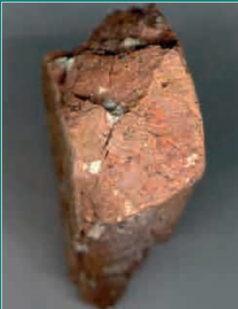
FIGURA 5 Fragmento de cerámica con un grano de cal, cuya hidratación y carbonatación ha producido tensiones que se traducen en grietas claramente visibles en la imagen.
