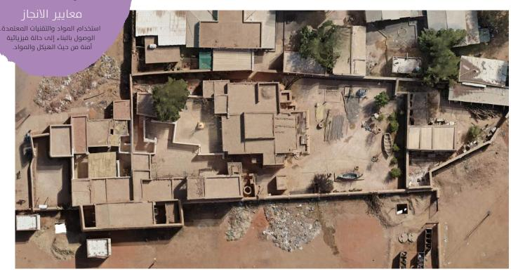
An aerial view of Khalifa House during the restoration work. It shows water drainage wells and shades that were added to the site صورة جوية لبيت خليفة أثناء أعمال الترميم تظهر فيها آبار تصريف المياه والمظلات التي أضيفت علم الموقع
