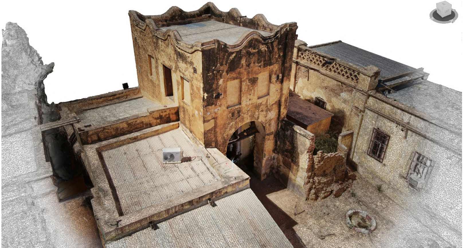
A 3D model of the Gate building in El Obeid city shows the stages of the model's production through computer applications نموذج ثلاثي الأبعاد لمبنى البوابة في مدينة الأبيض يبين مراحل إنتاج النموذج عبر تطبيقات الحاسوب
